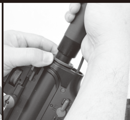
⑫①～③と逆の手順で、ストックチューブを取り付け、ストックを取り付け、完了!
