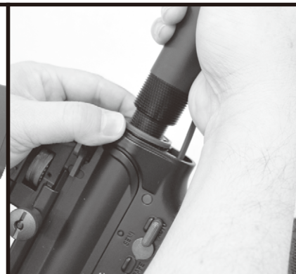
③ストックパイプを回し、取り外します
