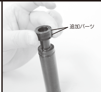
⑥リコイルウェイトの頭に追加パーツを1つはめ、ハンマーで軽く叩き込みます
