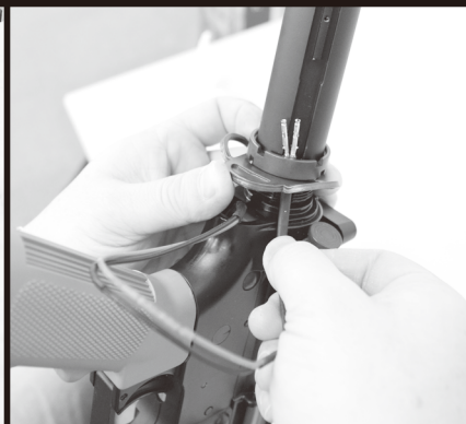
㉒ストックチューブの溝とストックチューブ・ロックリングの切りかき部分から、ワイヤーを通します
