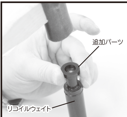
⑮リコイルウェイトの頭に追加パーツを1つはめ、ハンマーで軽く叩き込みます
