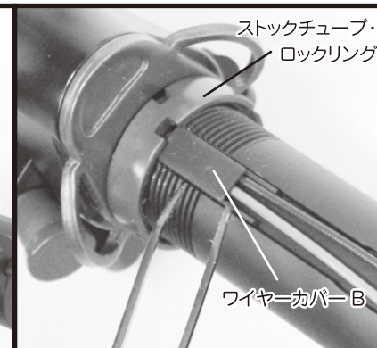
④ワイヤーカバー B をストックチューブ・ロックリングから引き抜き、外します
