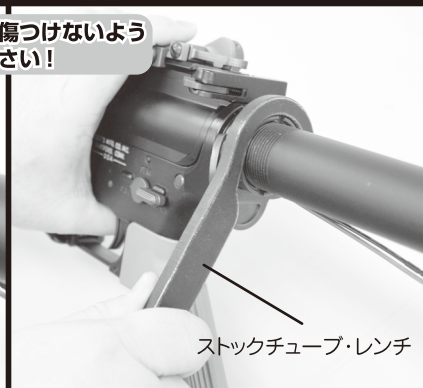
⑦ストックチューブ・ロックリングは大変固く締まっているので、ストックチューブ・レンチを使用して回します
