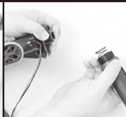
⑬ストックチューブ内にはスプリングが入っていますので、飛び出さないよう注意しながら外してください
