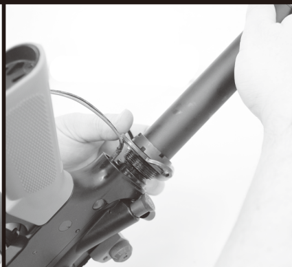
㉑ストックチューブをフレームにゆるめに取り付けます
