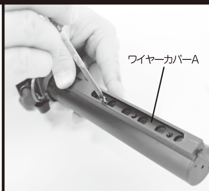
㉗ワイヤーカバー A をネジ留めします
