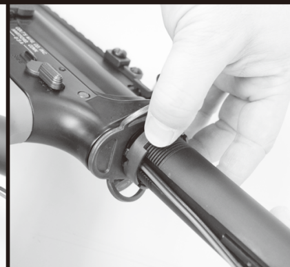
⑧ストックチューブ・ロックリングの切りかきと、ストックチューブの溝の位置を合わせます
