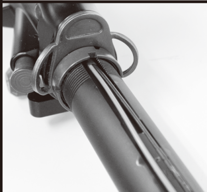
⑤ワイヤーがストックの溝に収まっているのを確認します※はみ出ていると、⑥の際にワイヤーが切れることがありますのでご注意ください!
