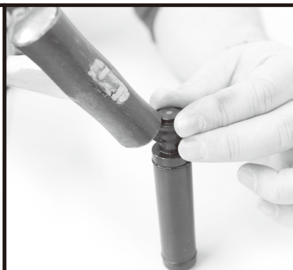
⑱追加パーツのフチを少しずつハンマーで叩き、奥まで追加パーツを叩き込みます
