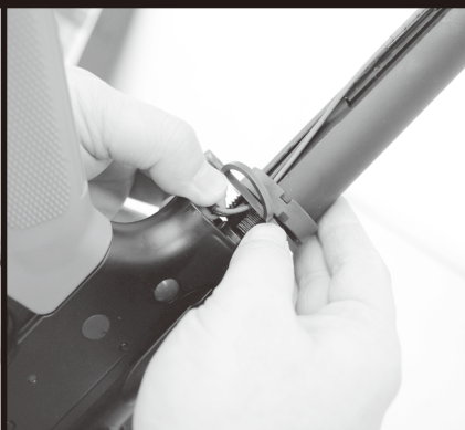
⑪痛めないよう気をつけながら、ワイヤーを引き抜きます
