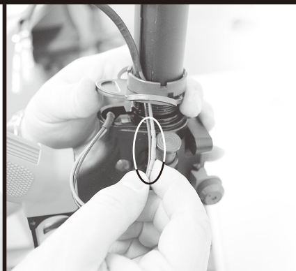
㉓ワイヤーの接続部分は、乱暴に扱っていると破れたり抜けたりするのでご注意ください
