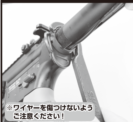
㉕ワイヤーが溝からはみ出していないか確認し、ストックチューブ・レンチでストックチューブ・ロックリングを閉めこみます
