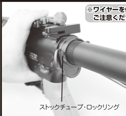
⑥ストックチューブ・ロックリングを緩めます
