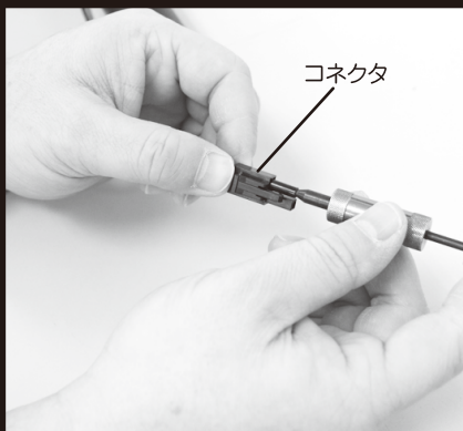
⑩ワイヤーのコネクタを取り外します ※専用の器具を使用すると便利です
