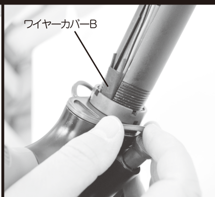
㉖溝にあわせて、ワイヤーカバー B をストックチューブ・ロックリングにはめ込みます
