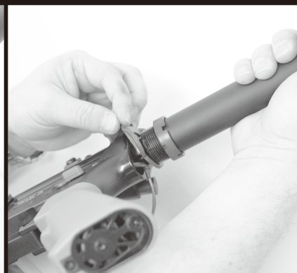
⑫ストックチューブを回して取り外します
