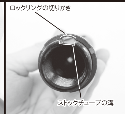
⑨切りかきと溝の位置を合わせると、写真のような状態になり、ワイヤーを引き抜く通り道になります
