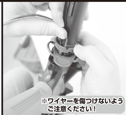
㉔ストックチューブの溝が真下に来よう、ストックチューブを締め込みます
